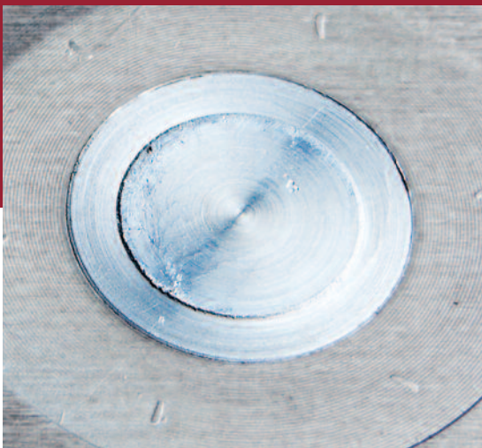
Oberfläche eines Schweißpunktes →
